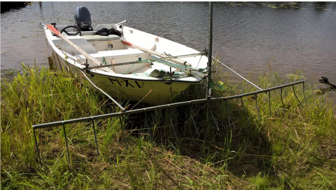
Kuva 5: Korjuuveeneen iso harava on tarpeen, jotta kasvit saadaan kerättyä vedestä.
